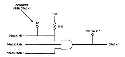
FIGURE 7-6. DTACK\* Signal Generation
