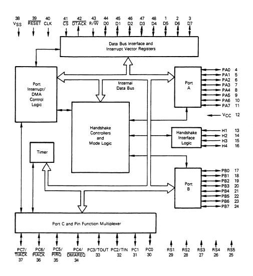
FIGURE 6-3. MC68230 PI/T Block Diagram
