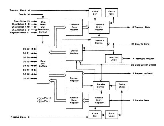
FIGURE 6-2. MC6850 ACIA Block Diagram
